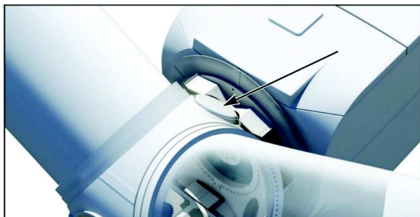
Figure 9 : L'accès dans le moyeu du rotor
